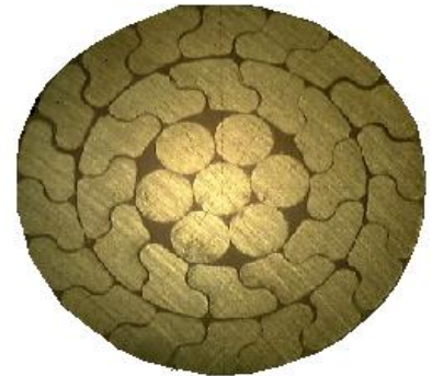
Figure III.12 : câble bi-métallique Constitué de brin extérieur en Z
