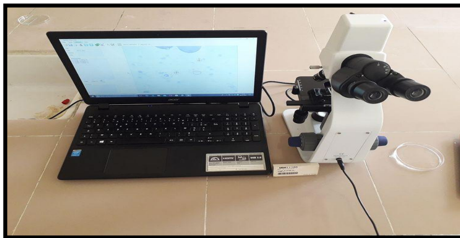
Figure 19: Microscope optique « Optika vision lite 2.1 » relié à un ordinateur comportant le logiciel de mesure des oocystes sporulés (original 2021).
