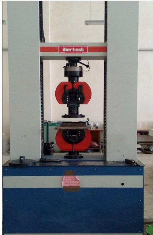
Figure II.125 : Machine d'essais de compression IBERTEST 200KN
