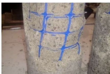
Figure III.12 L'éprouvette h/d=2 après écrasement. Enrobage 1cm
