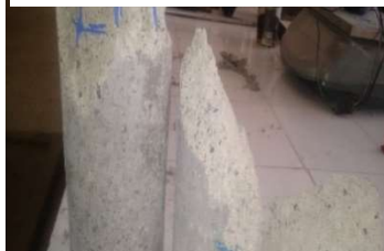
Figure III.11 Comparaison entre l'éprouvette confinée et non confinée après écrasement
