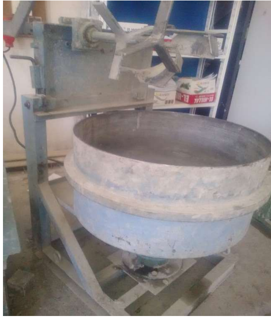
Figure II.3 Mélange des constituants du béton avec le malaxeur.
