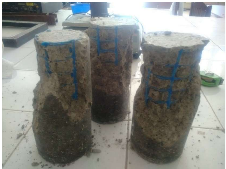
Figure III.19 Eprouvettes h/d=2 après rupture. Enrobage 2cm
