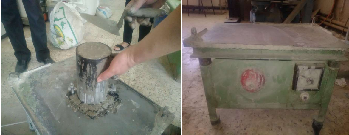
Figure II.81 : Compactage et vibration des éprouvettes.
