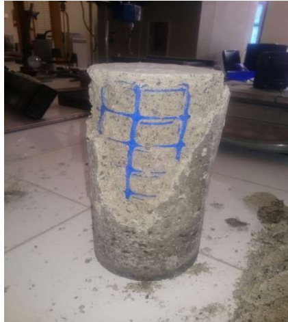
Figure III.3 Mode de rupture du béton confiné h/D=2 ; enrobage 1 cm
