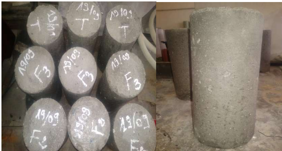
Figure II.103 : Démoulage des éprouvettes en béton.
