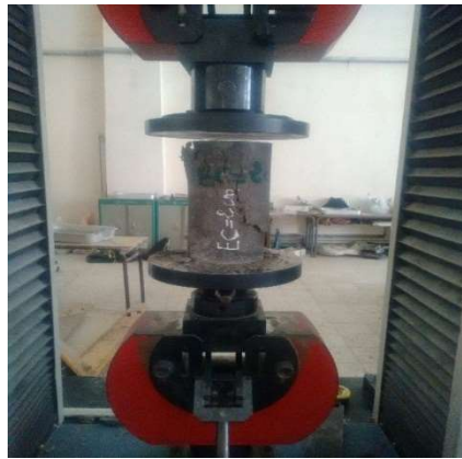
Figure III.5 Mode de rupture du béton confiné h/D=2 ; enrobage 2 cm
