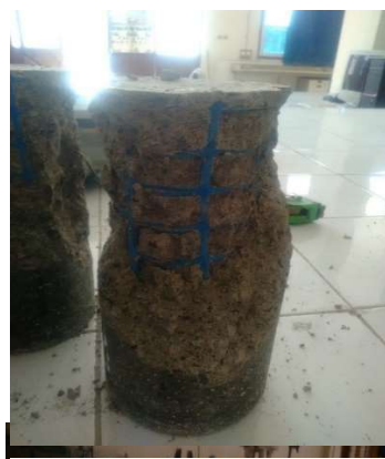
Figure III.10 L'éprouvette h/d=2 après écrasement. Enrobage 2cm
