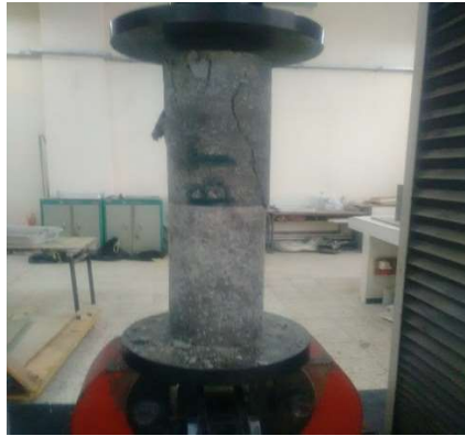
Figure III.14 Mode de rupture du béton témoin h/d=4
