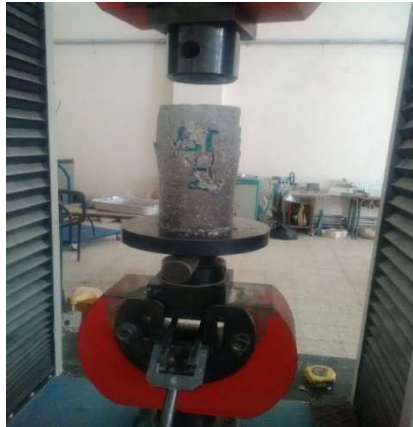
Figure III.1 Mode de rupture du béton témoin h/D=2
