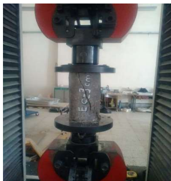
Figure III.7 aspect de l'éprouvette h/D=2 ; enrobée a 3cm après écrasement
