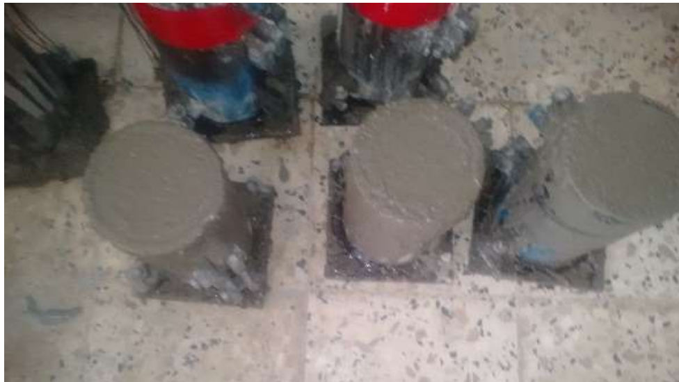
Figure II.92 : Arasement des surfaces des éprouvettes.
