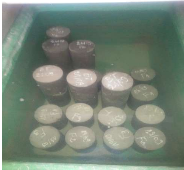
Figure II.114 : Cure d'hydratation des éprouvettes en béton.
