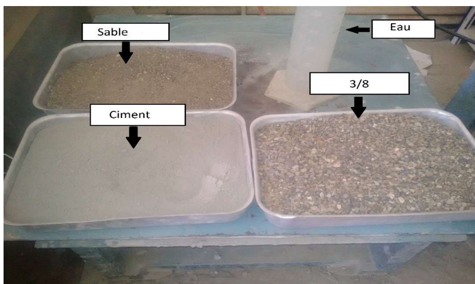
Figure II.1 Constituant du béton
