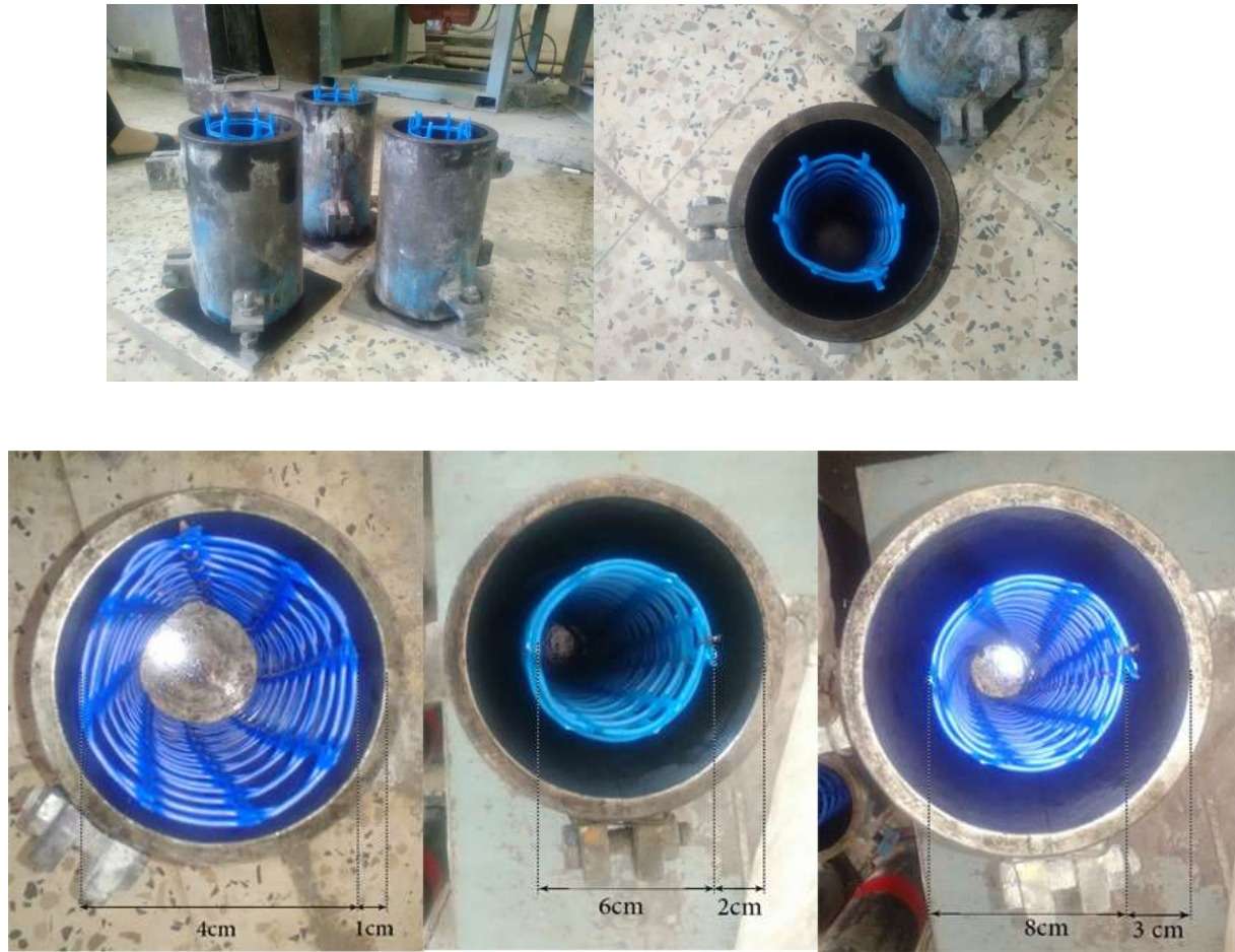
Figure II-10 : mise en place des grilles dans les moules
