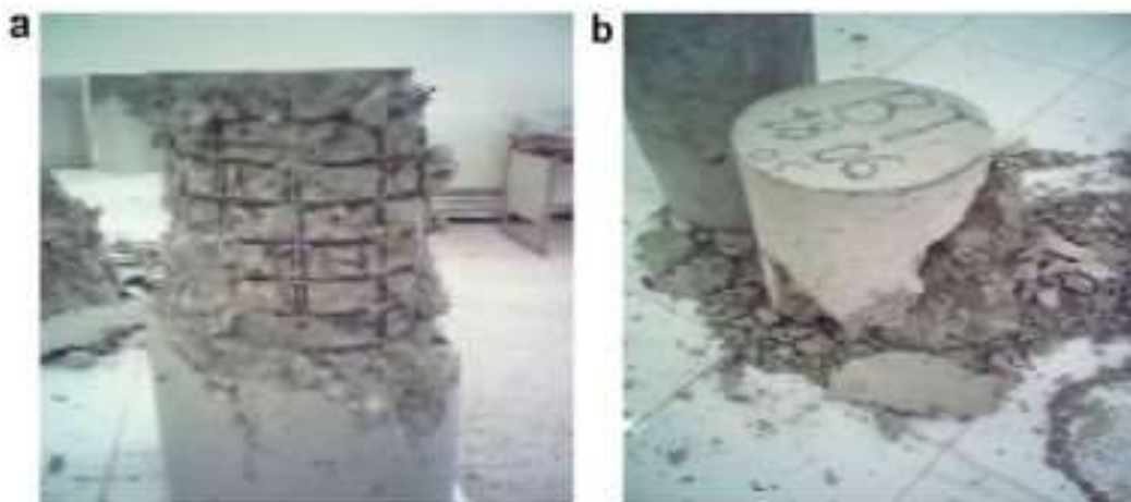
Figure I.26 Mode de rupture des spécimens, (a) béton confiné et (b) béton non confiné.
