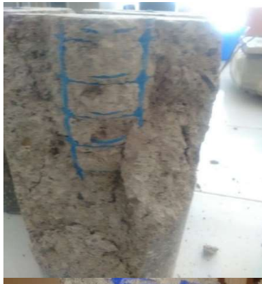
Figure III.9 L'éprouvette h/d=2 après écrasement. Enrobage 3cm
