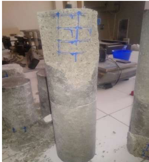
Figure III.16 Mode de rupture du béton confine h/d=4 . Enrobage 2 cm
