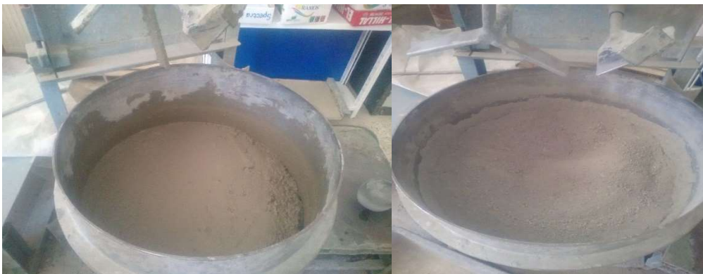
Figure II.4 : Malaxage du béton.
