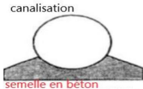
Figure VI.1 : Pose de conduite en tranchée dans un terrain peu consistant.
