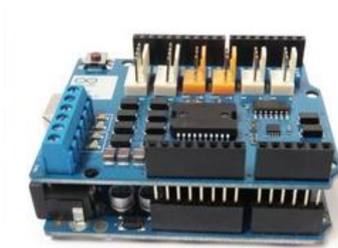
Figure 66 : Shield moteur monté sur une carte Arduino Uno.
