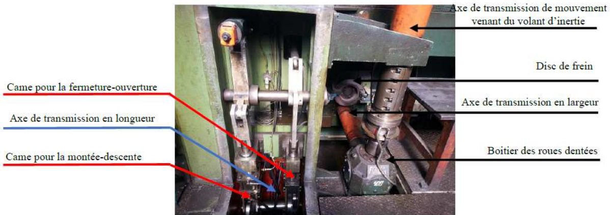
Figure 1-10 : Mécanisme de transmission des mouvements
