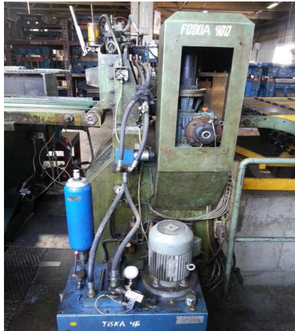
Figure 1-8 : Le groupe alimentateur et cisaille
