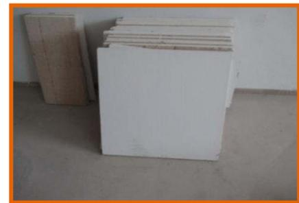
*Figure 130: les plaques en plâtre
