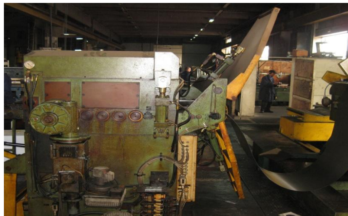
Figure. II.4 : Le bloc redresseur.
