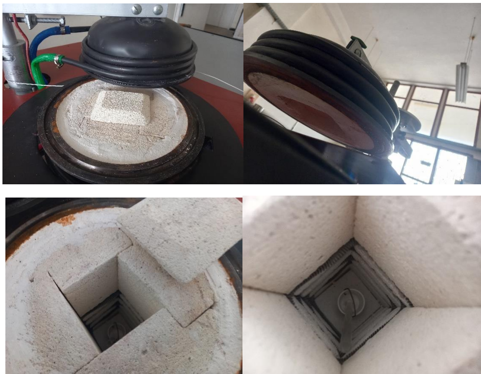
Figure 3 : Vues du four à son ouverture : en haut à gauche vue générale, à droite vue de dessous montrant le creux dans la brique du couvercle ; en bas vue de dessus de la chambre de confinement contenant une nacelle en alumine, n forme de panier.
