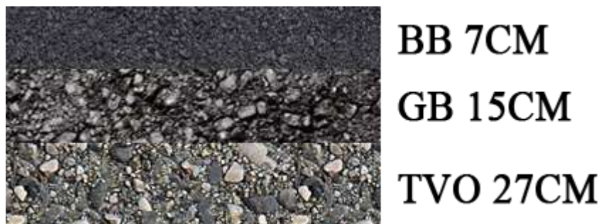
Figure 42: Corps de chaussée final retenu
