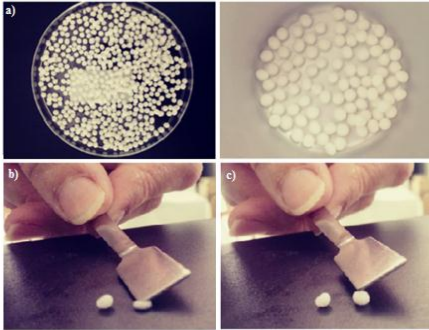
Figure IV. 14. Aspect des billes lyophilisées (a), test à l'écrasement (b), reprise de la taille initiale à la levée de la contrainte (c).
