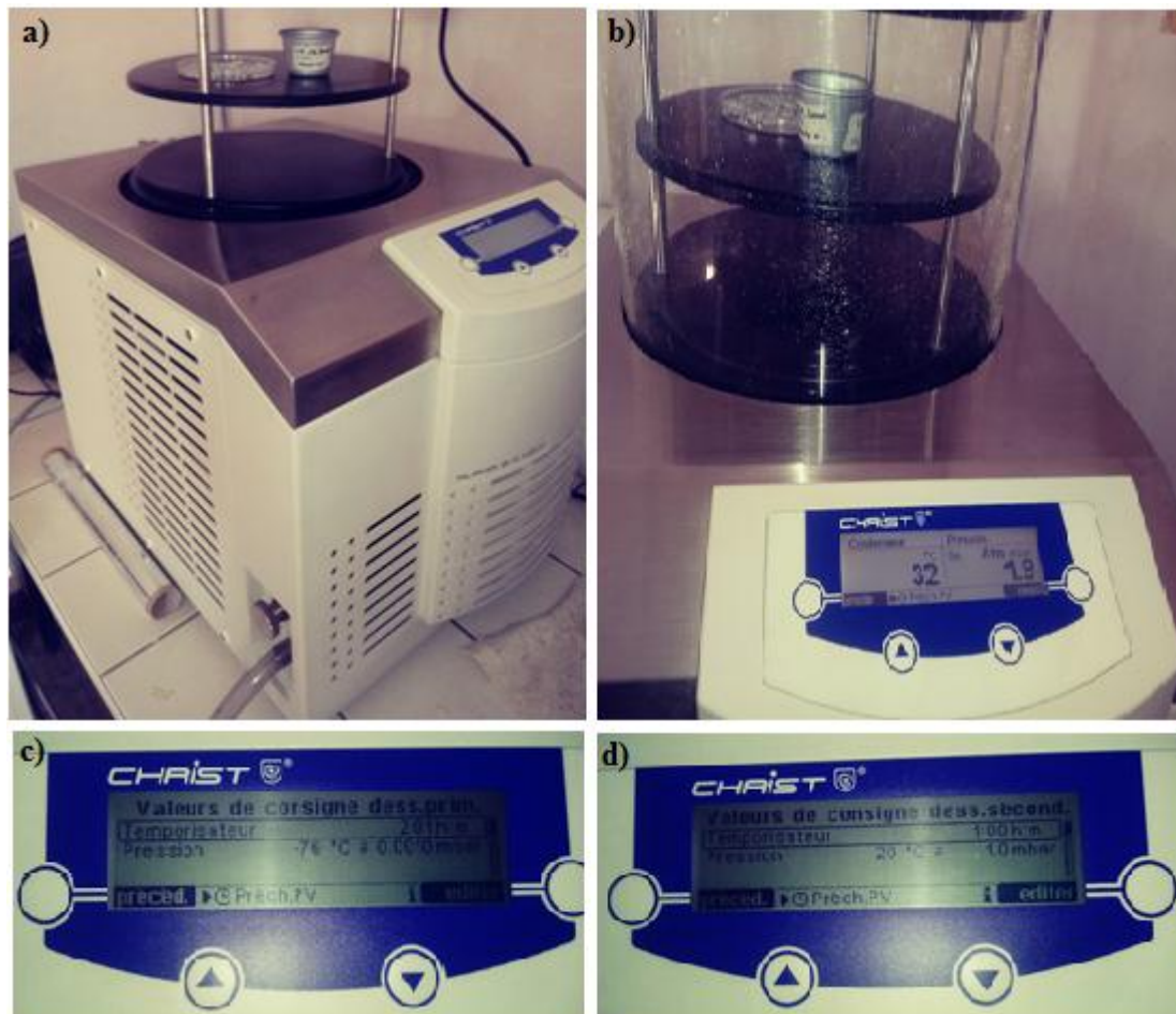
Figure IV. 7. Préparation de la lyophilisation des billes d'Alginate de calcium encapsulant le fénofibrate. a) lyophilisateur Cryo-Christ® 2-4 LD plus avant sa mise en marche, b) mise en place de l'échantillon et fermeture de l'enceinte, c) édition des valeurs de consignes pour la dessiccation secondaire.
