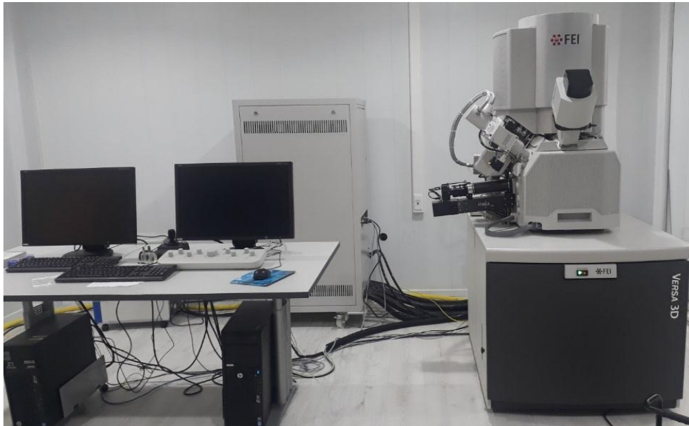
Figure IV. 11. Microscope électronique à balayage FEI® Versa 3D.
