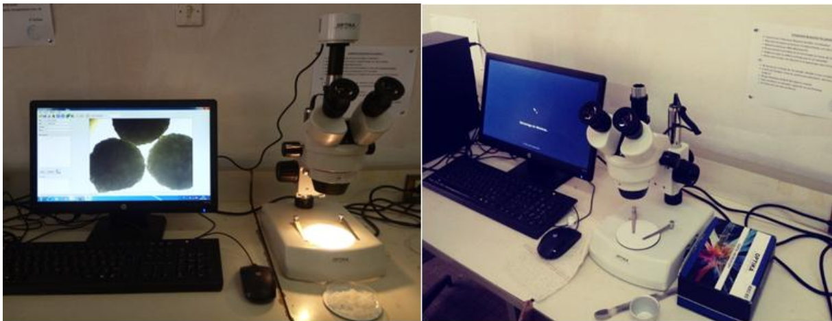
Figure IV. 9. Analyse de la taille des microsphères au microscope optique à caméra OPTIKA®.
