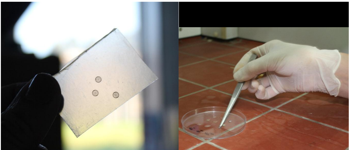
Figure I. 9. Technique d'habillage des grilles et de préparation de l'échantillon pour analyse au microscope électronique à transmission.
