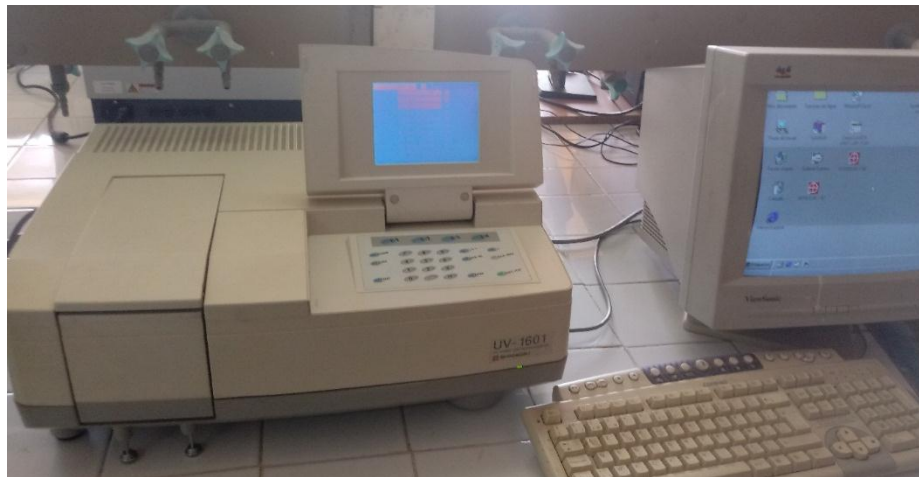
Figure IV. 28. Spectrophotomètre UV-Visible à double faisceau SHIMADZU® UV-1601.
