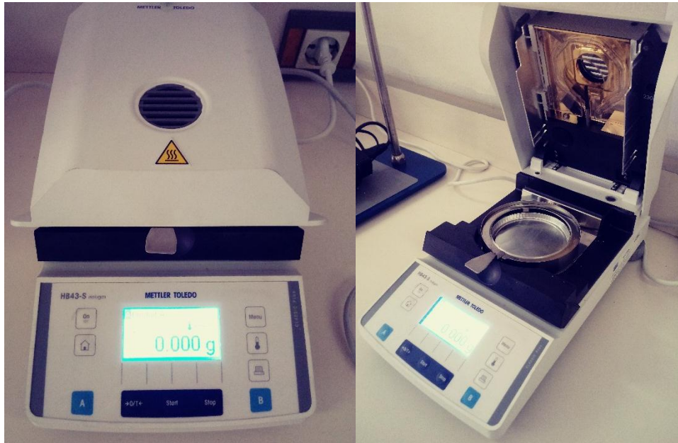
Figure IV. 10. Dessicateur à infrarouges Mettler Toledo®TM HB43-S Halogen.
