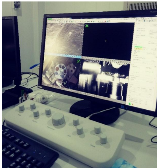
Figure IV. 12. Ecran d'observation de l'analyse de la surface d'un échantillon de billes au microscope électronique à balayage.
