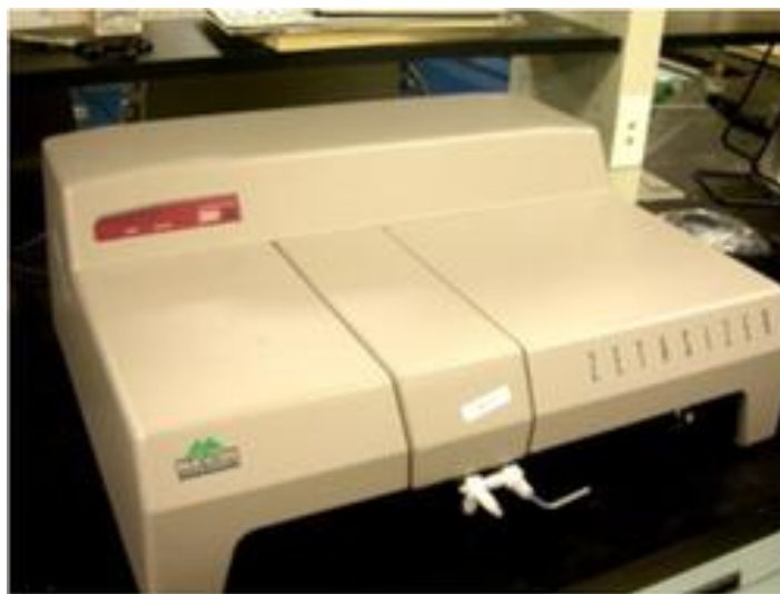
Figure I. 2. Zetasizer 3000 HS, Malvern® pour la mesure du potentiel zêta.
