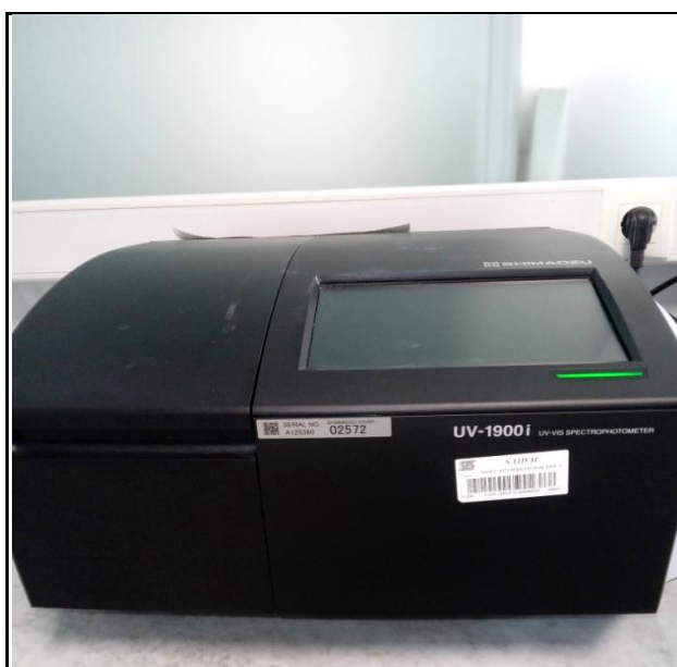
Figure 32: Lecture des échantillons au spectromètre UV (Originelle, 2025).
