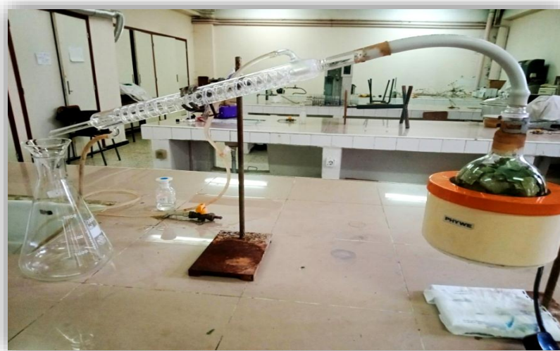
Figure 51: Extraction par hydro distillation des huiles essentielles à l'aide de l'appareil de clevenger (Originelle, 2025).
