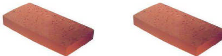
Figure I.2 : Brique en terre cuite pleine.
