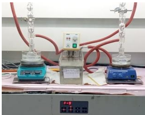
Figure N°3 : échantillon du répaglinide en suspension dans l'eau porté à reflux.
