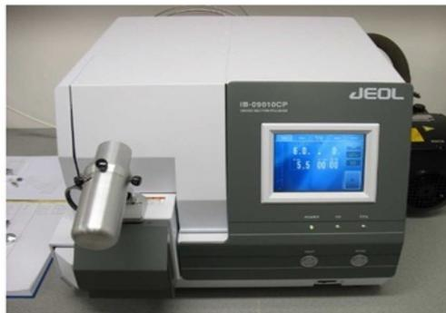
Figure III.4 : Polisseuse ionique (Cross Section Polisher JEOL IB-09010CP).
