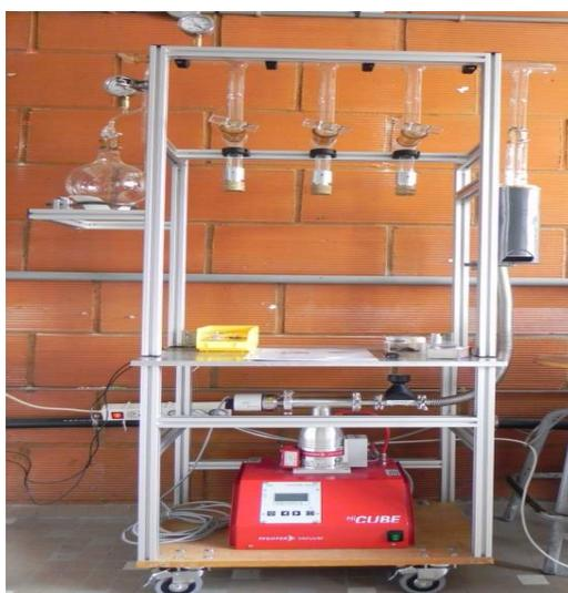
Figure III.3 : Dispositif du vide secondaire.
