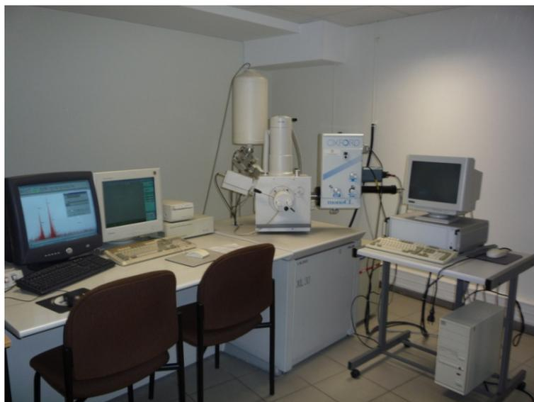
**Figure III.6 :** Microscopie électronique à balayage (MEB) à émission de champ (FEG-SEM JEOL J7600F).
