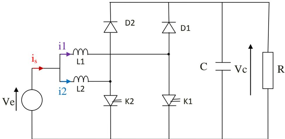
Figure II-9 : Mise en parallèle de deux boost
