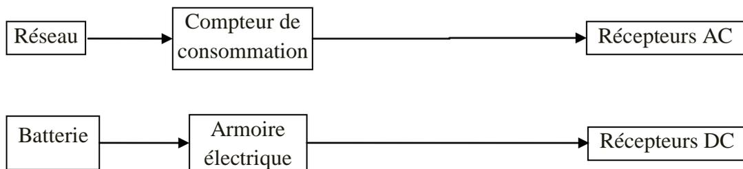
Figure III-3 : Répartition d'énergie pour un système photovoltaïque raccordé au réseau
