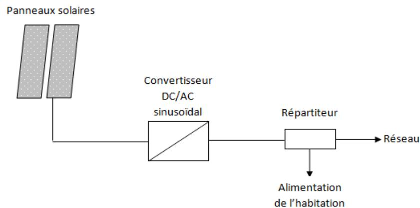
Figure I-21 : Système photovoltaïque raccordé au réseau
