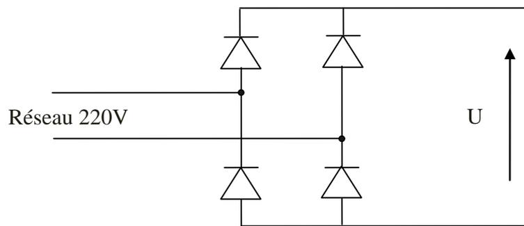
Figure III-8 : Pont à 4 diodes (pont de Greatz)
