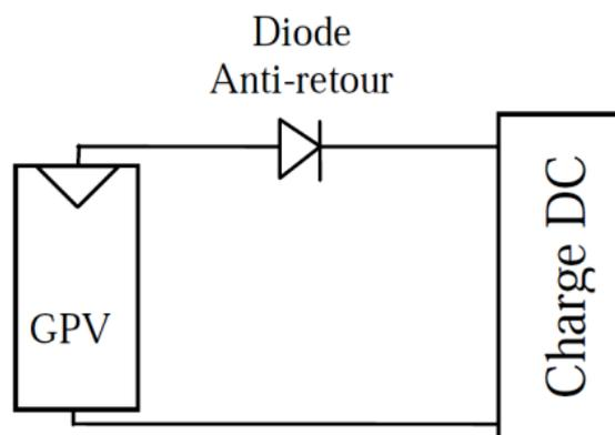
Figure II-3 : Connexion directe GPV-Charge via une diode anti-retour.
