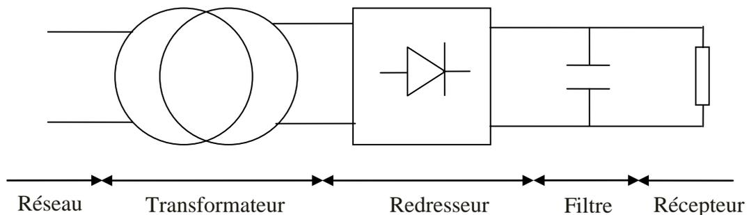
Figure III-6 : Principe de fonctionnement du 1er type d'adaptateur
