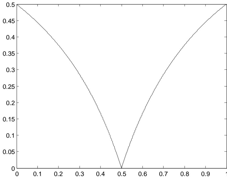
Figure II-13 : Variation du rapport des ondulations de la tension de charge en fonction de  $\alpha$
