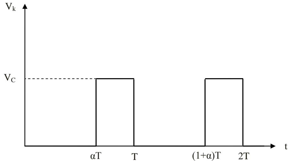
Figure II-6 : Allure de la tension aux bornes du thyristor
