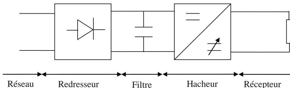
Figure III-7 : Principe de fonctionnement du 2eme type d'adaptateur
