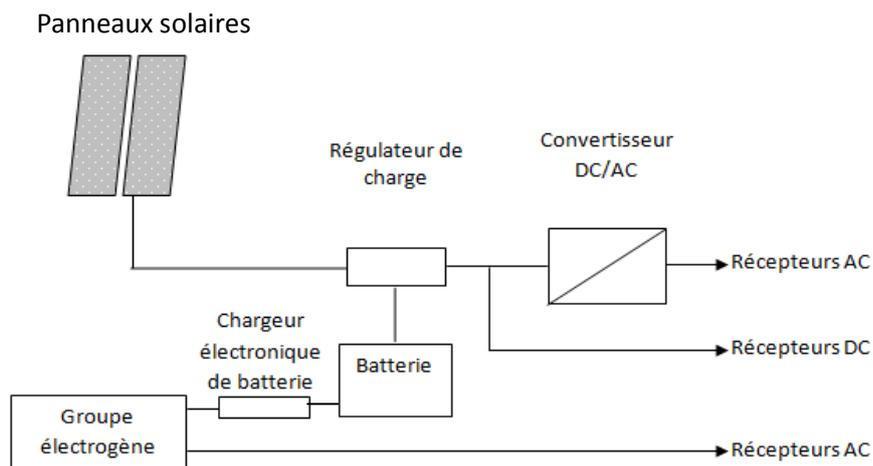
Figure I-20 : Système d'alimentation autonome hybride photovoltaïque/groupe électrogène
