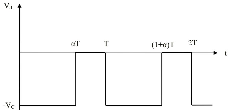
Figure II-7 : Allure de la tension aux bornes de la diode
