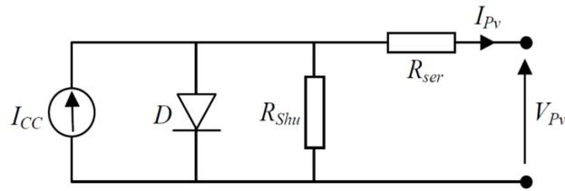
Figure I-11 : Schéma équivalent d'une cellule solaire
