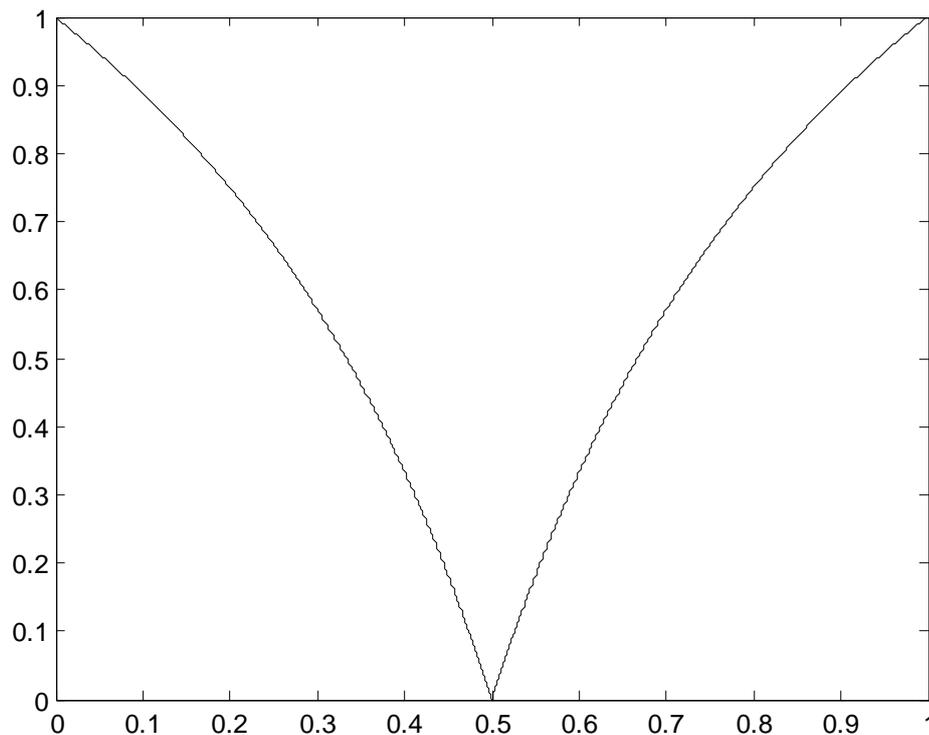
Figure II-12 : Variation du rapport des ondulations du courant de source en fonction de  $\alpha$
