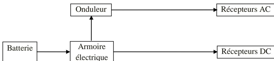
Figure III-4 : Répartition d'énergie pour un système photovoltaïque isolé
