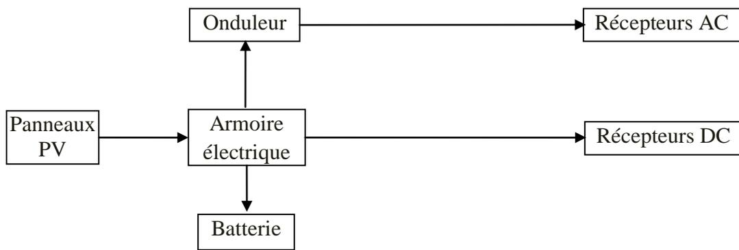
Figure III-2 : Répartition d'énergie pour un système photovoltaïque isolé.
