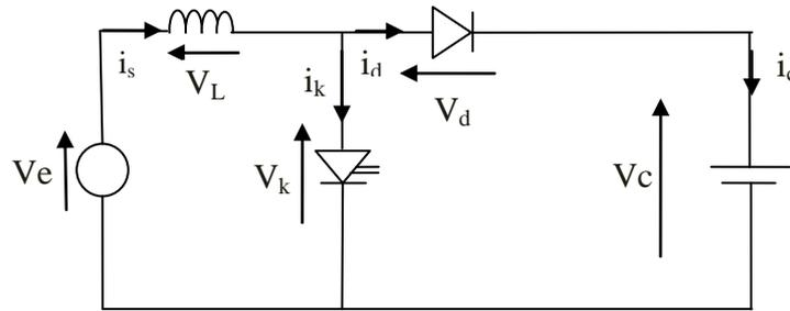
Pour  $t \in [0 \text{ à } \alpha T]$  K conduit, D ouverte
