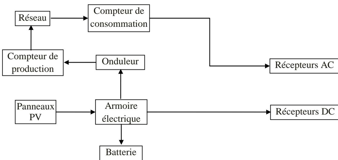
Figure III-1 : Répartition d'énergie pour un système photovoltaïque raccordée au réseau
