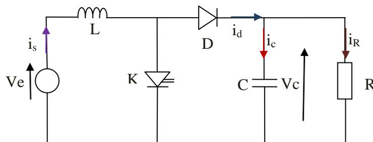
Pour approximer cette ondulation, nous supposons que le courant de source et le courant traversant la résistance sont constants,  $i_s = I_{s_{moy}}$  et  $i_R = I_R$  avec :  $I_R = I_{s_{moy}} \cdot (1 - \alpha)$
