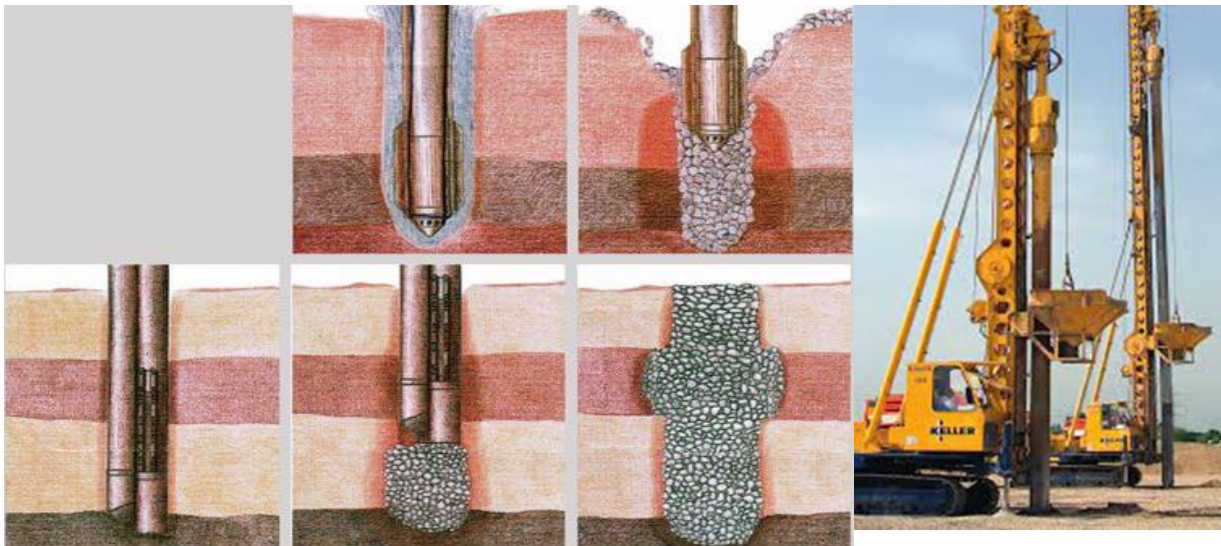
Figure II.20 : Technique de mise en œuvre des colonnes ballastées (Ammar Dhouib et Francis Blondeau, 2005)
