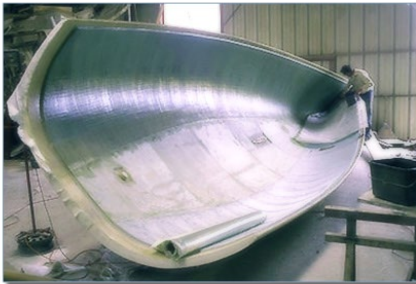
Figure 8: fabrication d'une barque en matériaux composites
