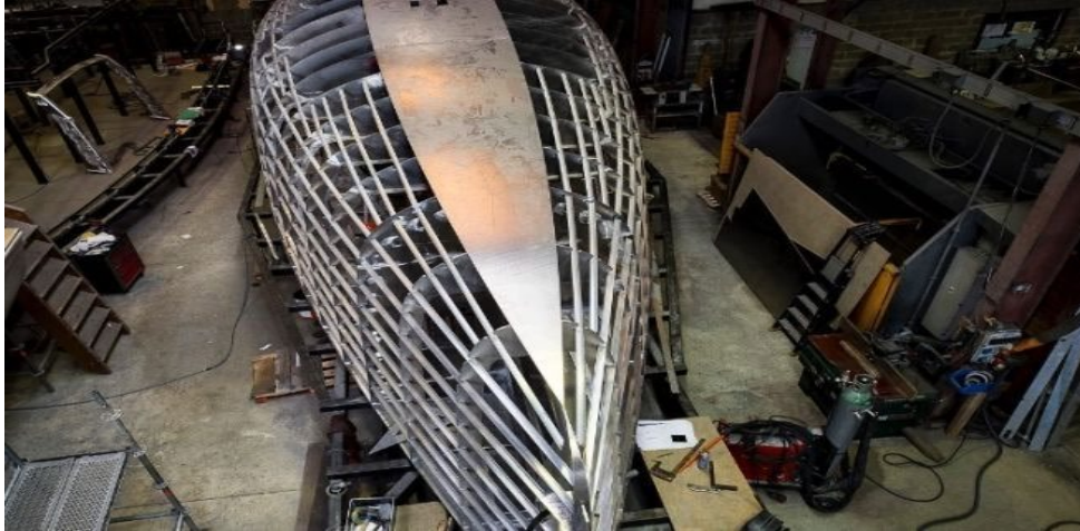
Figure 6: fabrication de bateau en aluminium
