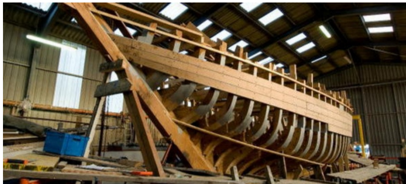
Figure 7: fabrication de bateau en bois
