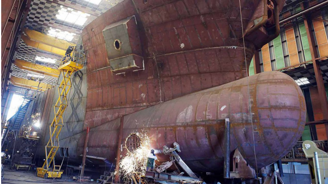
Figure 5: Fabrication de bateau en acier
