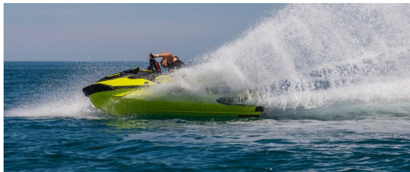
Figure 21: scooter de mer avec propulsion à réaction hydrojet
