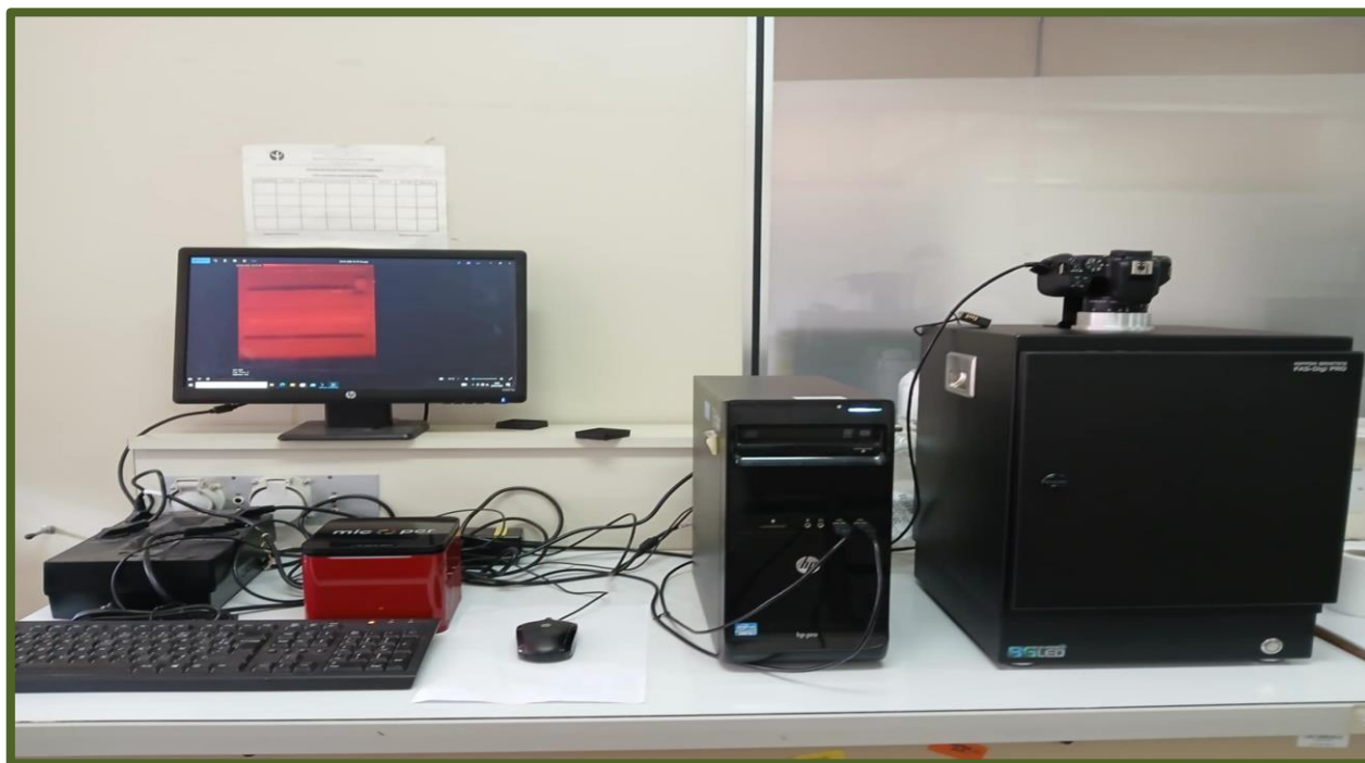
Figure 29 : Visualisation des fragments d'ADN amplifiés sur un Gel Doc ( Originale, Institut Pasteur, 2025 ).
