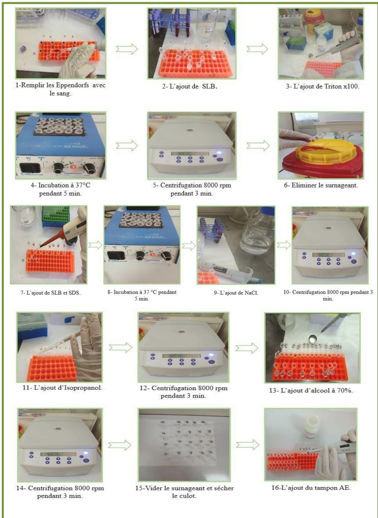
Figure 24 : Les étapes d'extraction d'ADN SALTING OUT (Originale, Institut Pasteur, 2025).
