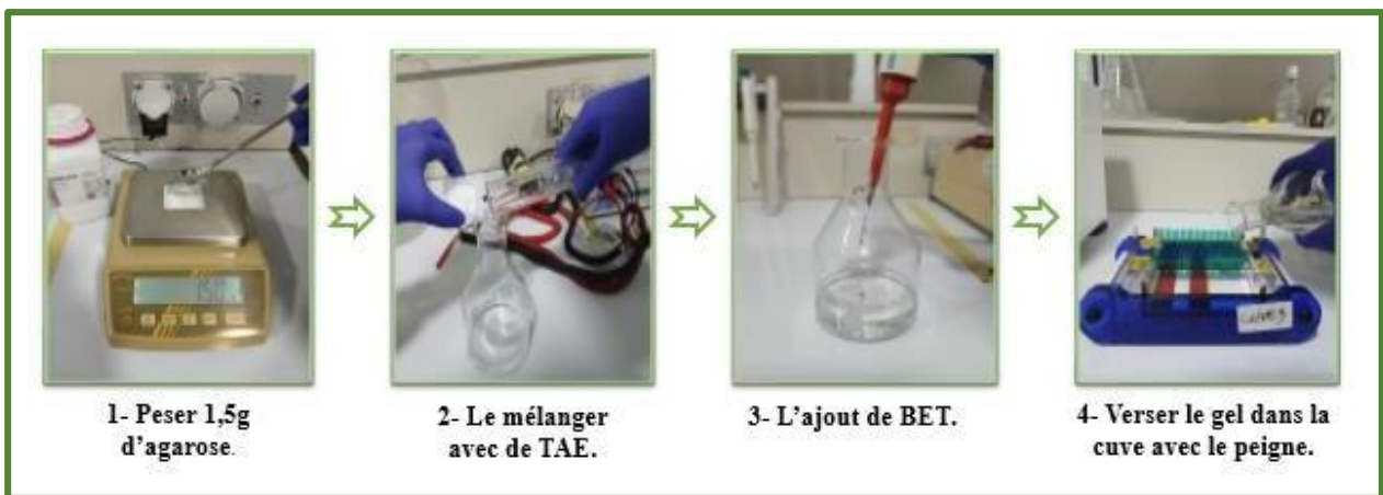
Figure 27 : Préparation de gel d'agarose (Originale, Institut Pasteur, 2025).
