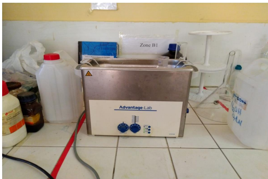
Figure 20: Sonicateur : homogénéisation du mélange. Laboratoire de chimie analytique 2020.
