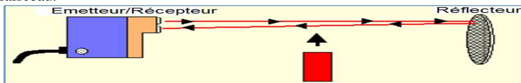
Figure I.24 : Représentation d'un système reflex.
