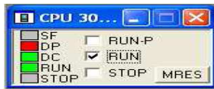
Figure IV.4 : Mise en marche de la CPU.
