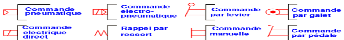
Figure I.14 : Symbolisation des différents types de commande d'un distributeur.
