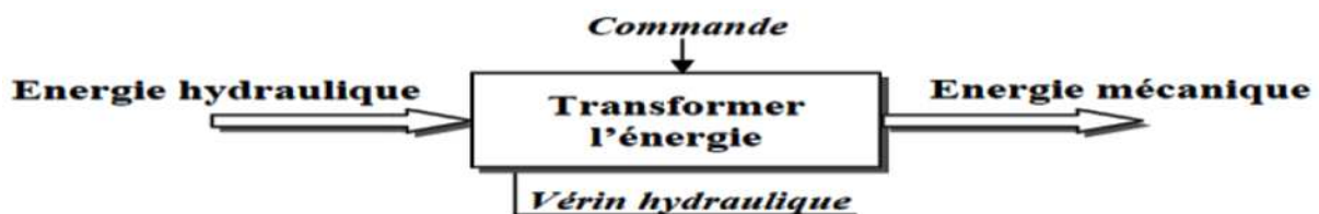
Figure I.8 : Schéma fonctionnel d'un vérin hydraulique.
