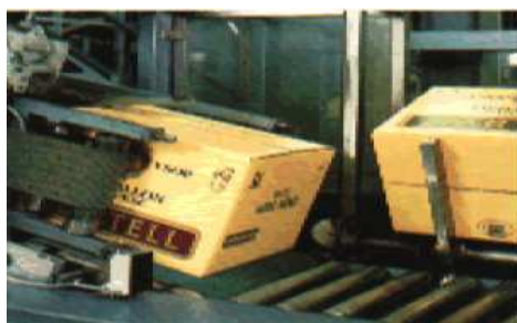
Figure I.19 : Image d'un capteur de présence et de son Signal TOR.
