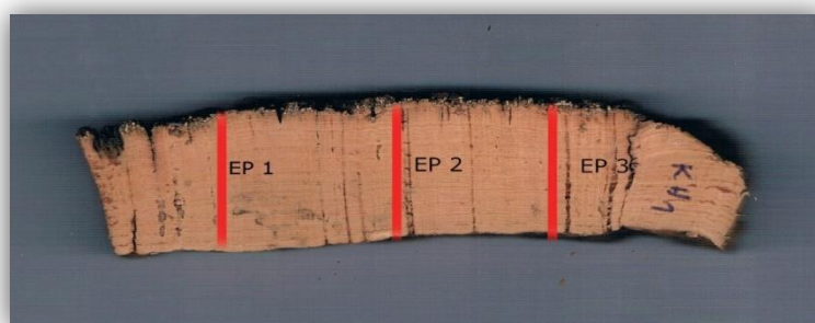
Figure 10 : Prélèvement des éprouvettes de liège pour mesurer l'épaisseur des cernes.
