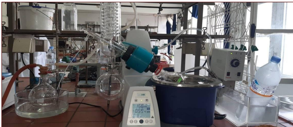
Figure 14 : évaporateur rotatif de type Heldolphlaborota 4001-efficient .
