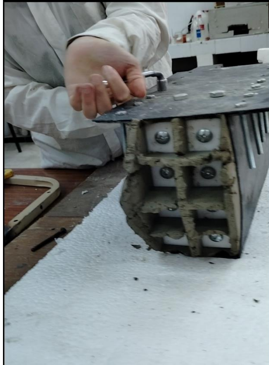
Figure III-7: Le moule déformé
