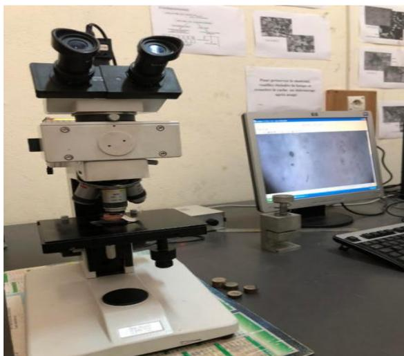
31 Figure III.17 : Microscope optique de type « HUND WETZLAR ».
