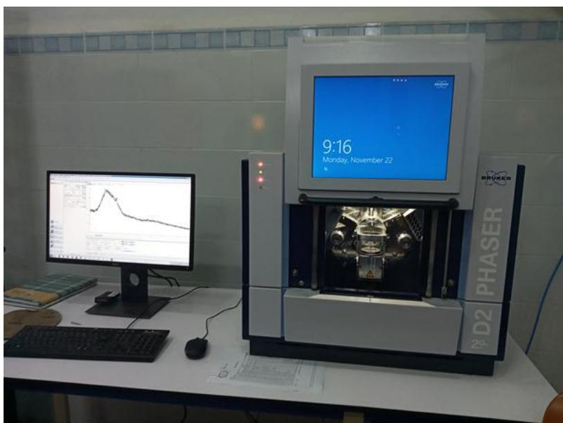
*17Figure.III.1Diffractomètre D2 PHASER(BRUKER)*
