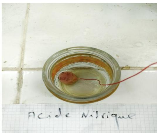
32 Figure III.18 Échantillon d'acier AISI «316 durant le traitement chimique
