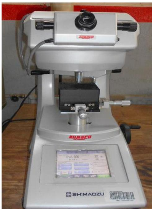
19Figure III.5 : Machine de mesure de la micro dureté modèle SHIMADZU.
