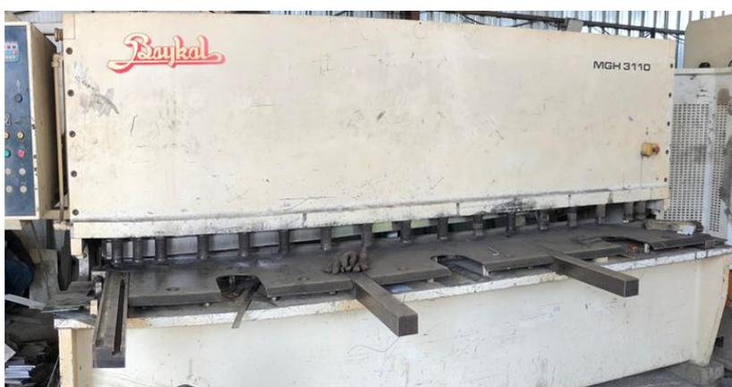
20Figure III.6 : Machine de découpe une guillotine (BAYKAL, MGH3110).
