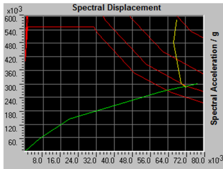
Figure V.18. Courbe de capacité de la structure à saillance supérieure à la norme.
