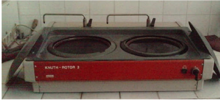
Figure 4.7 : Polisseuse électrique à deux disques.
