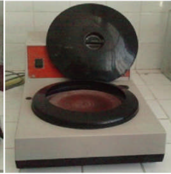
Figure 4.8 : Polisseuse de finition.
