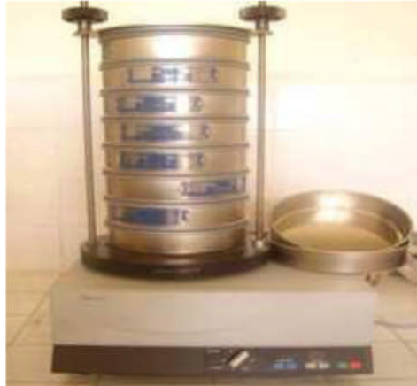
Figure 4.1 : Tamiseur de type RETSCH
