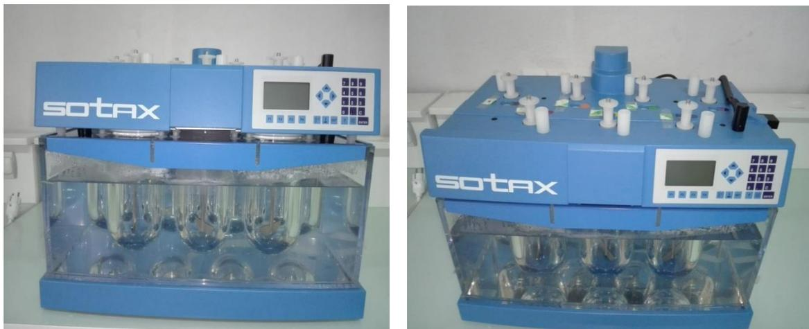
**Figure 07 : Appareil de dissolution marque SOTAX AT7 smart**
