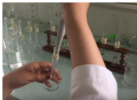
**Figure 17** : Dilution des échantillons
