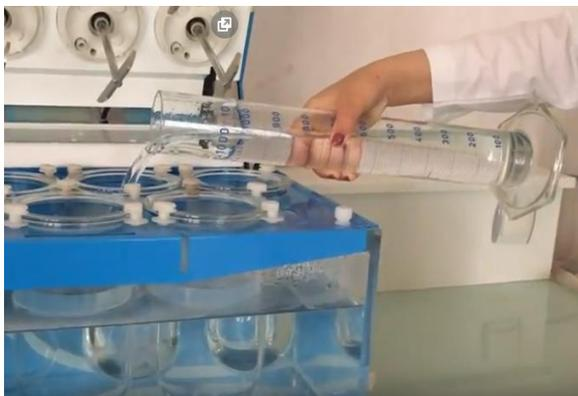
**Figure 13** : Remplissage des vases du dissolutest
