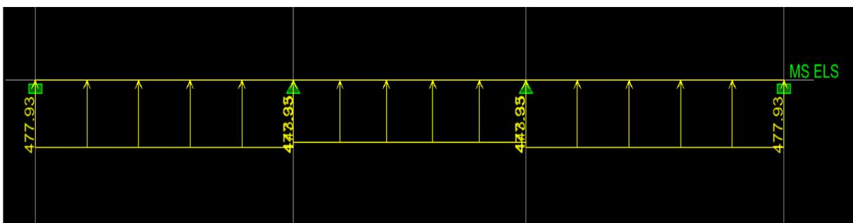
Figure VI-16 Schéma statique de la nervure ELS (sens longitudinal).
