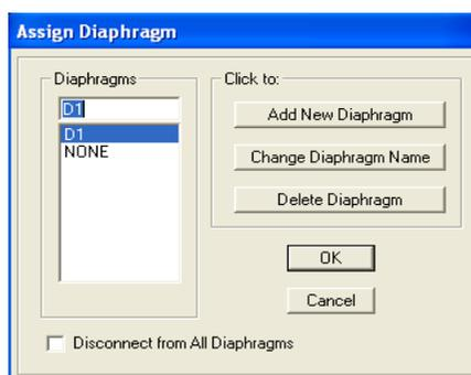
*fig IV.37 spécification de diaphragme de chaque plancher*
