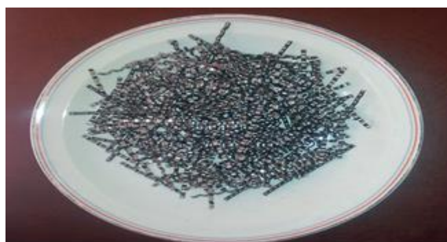
Figure II-9 fibres métalliques type (MEDAFAC)
