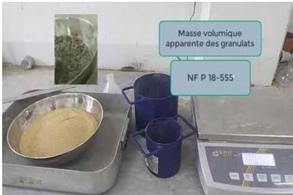
Figure II-4 mode opératoire de la masse volumique apparente
