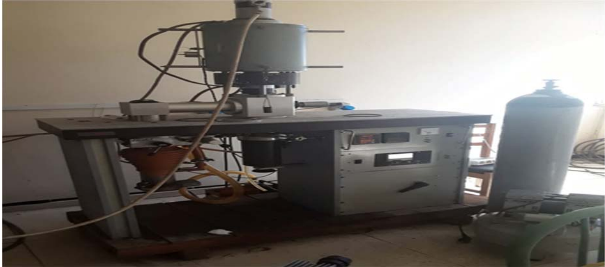
Figure II.3 Four de traitement thermique
