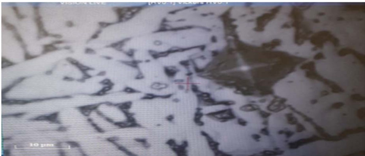
Figure II.10 Essai de microduromètre sur l'échantillon 6 après trempe.
