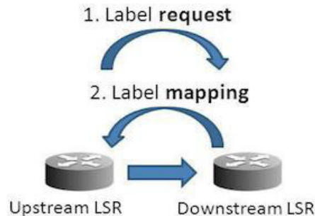
Figure I.10 : Principe du Downstream on demande.
