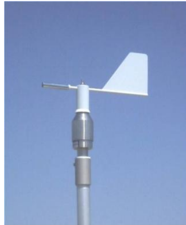
Figure I.19. Girouette reliée à la station automatique.
