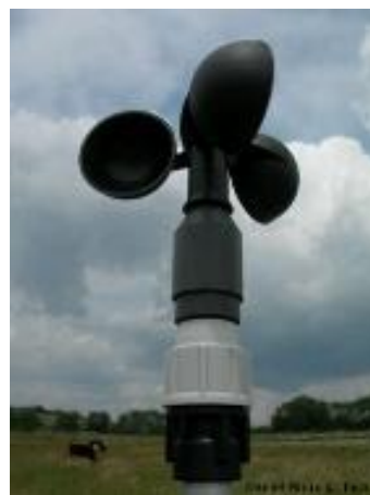
Figure I.18. Anémomètre relié à la station automatique.
