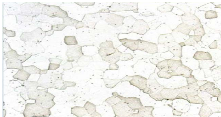
Figure I-8 : Structure d'un acier inoxydable ferritique.[16]
