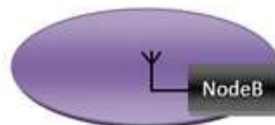
Node B avec antenne omnidirectionnel
