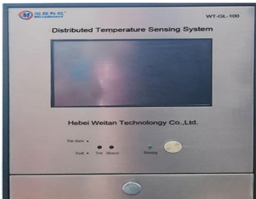
Figure III.5. Contrôleur de fibre optique DTS [42].
