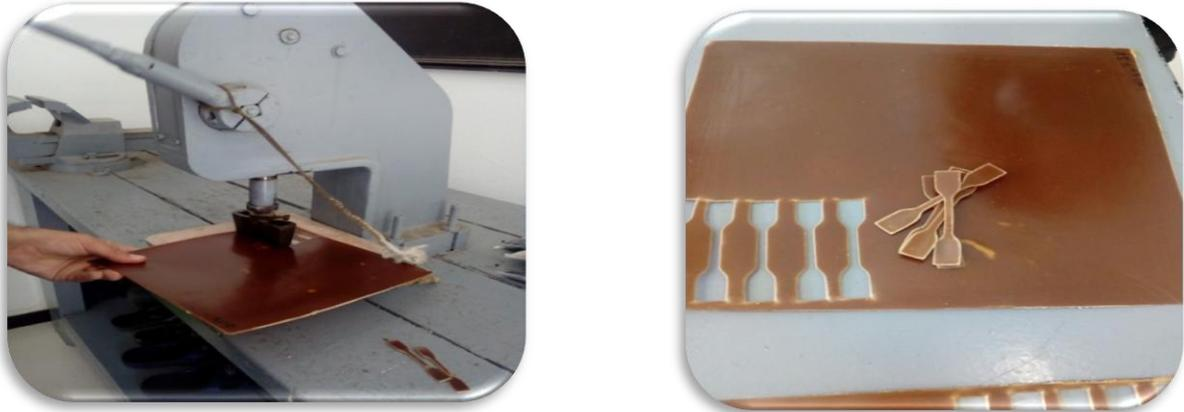
Fig III.21 Model des éprouvettes de type H.
