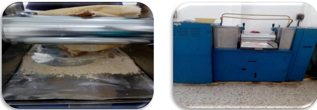
**Fig III.18:** Mélangeur à cylindres de SCUYER de type A 80.
