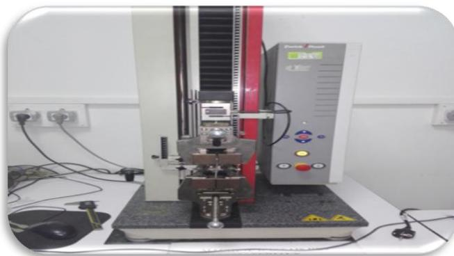
**Fig III.31:** Machine d'essai de traction de marque ZWICK de type BTC-FR 2.5TN.D09.
