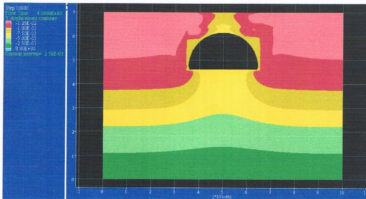
Fig.IV.37. Déplacement vertical du sol.
