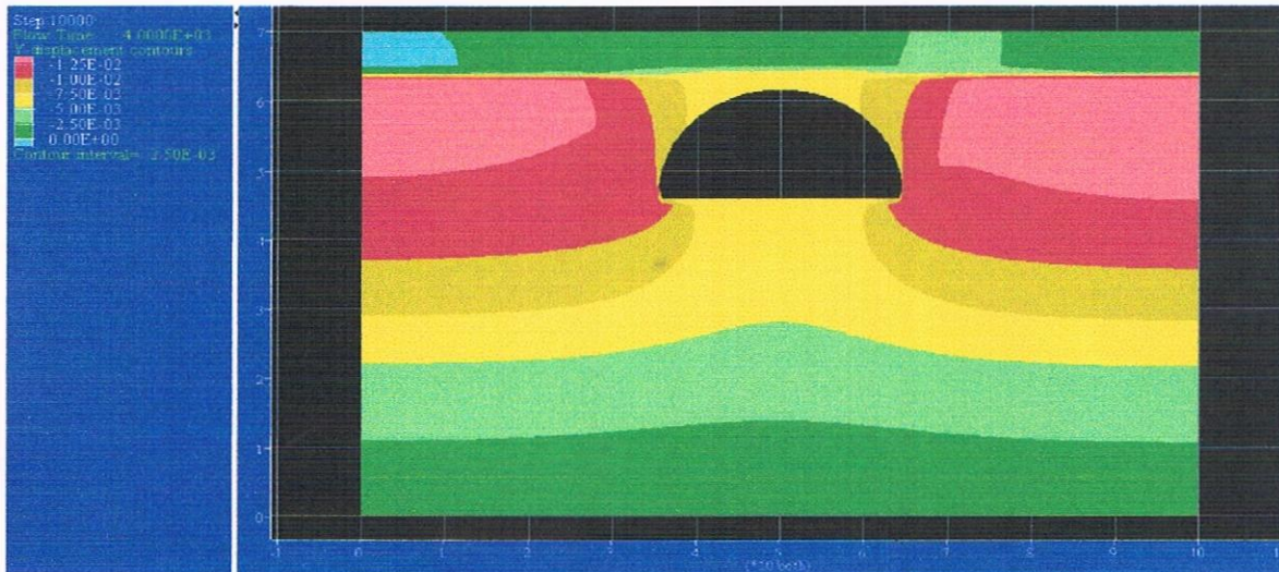
Fig.IV.22. Déplacement vertical du sol.
