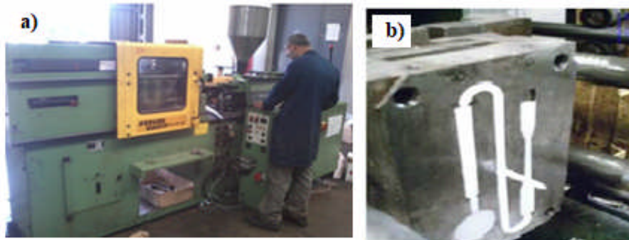
Figure III.09 : Procédé d'injection a) Machine à injection et b) moule d'éprouvettes normalisées.
