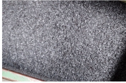
Figure III.08 : Grains résultants de la granulation des joncs du mélange Polymère recyclé/PP.
