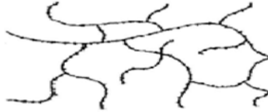
Figure I.07 : Représentation schématique d'un polymère tridimensionnel [6].
