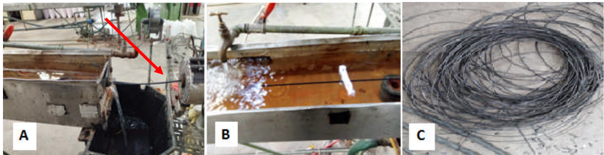
Figure III.06 : Déroulement de l'opération d'extrusion des mélanges a) La sortie de la matière de la filière de l'extrudeuse. b) refroidissement du jonc c) La matière finale.
