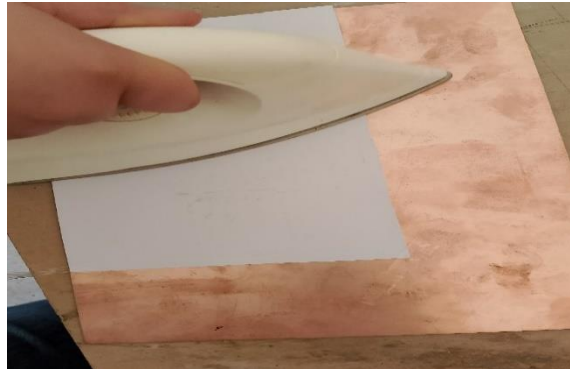
Figure III.16 : Fer à repasser sur le papier photo.
