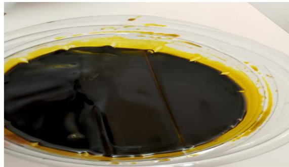
Figure III.17 : Passage de la carte cuivrée dans l'acide.
