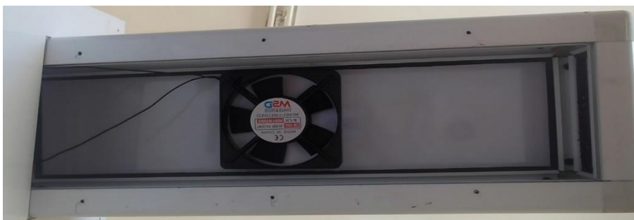
Figure III.23 : Vue du ventilateur installé, avant l'intégration de la plaque chauffante.
