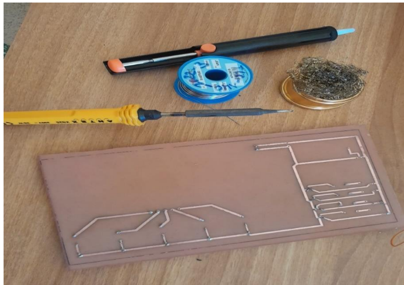
Figure III.19 : Soudage des composants sur la carte électronique
