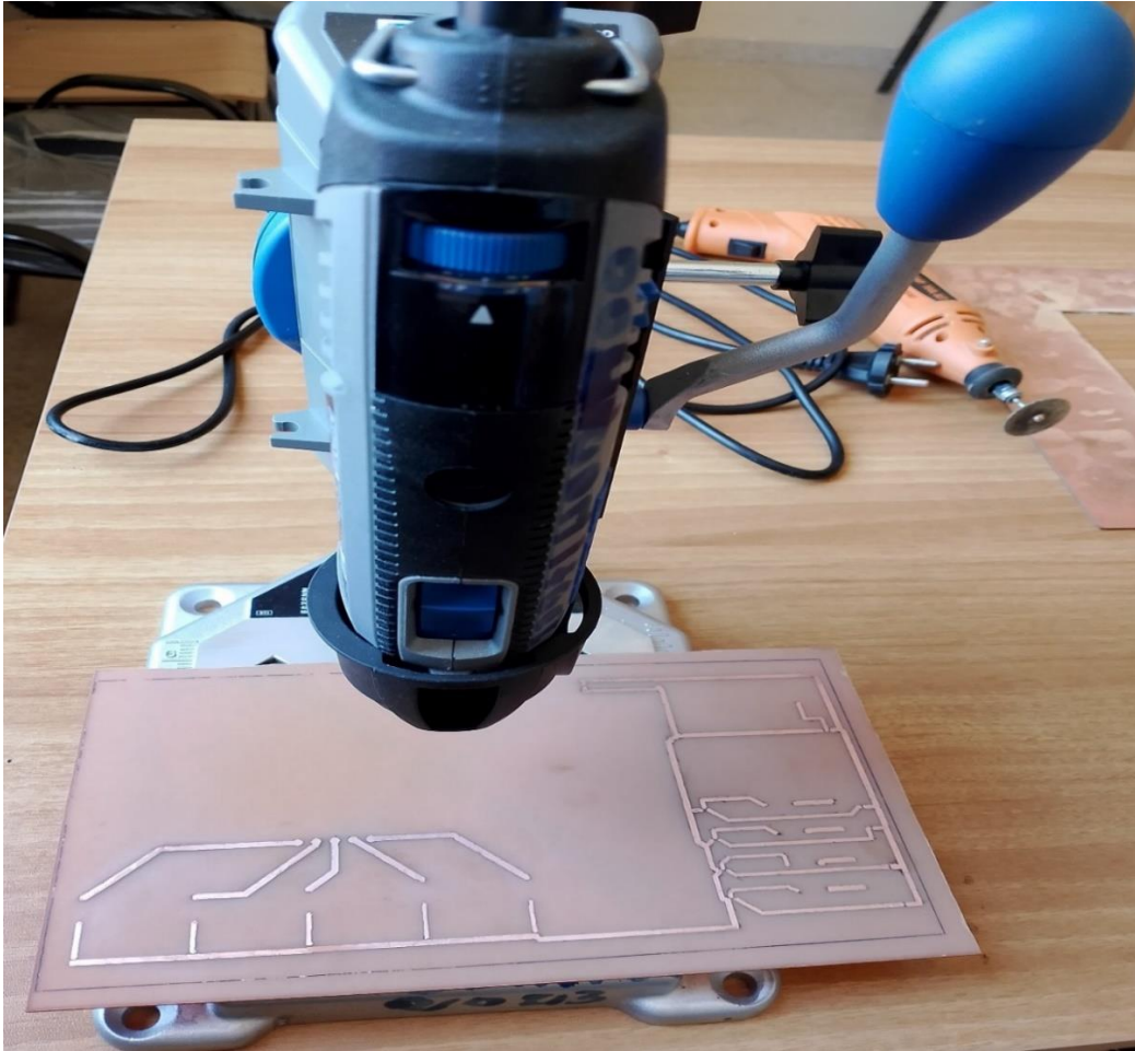
Figure III.18: Perçage de la carte électronique
