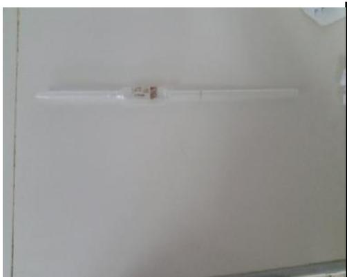
**Figure 13** : pipette graduée
