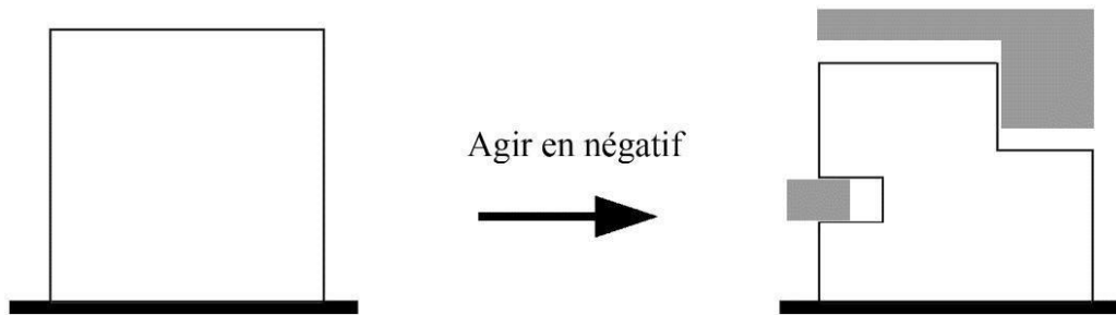
Figure 14 : Représentation d'une soustraction de parties d'un bâtiment.
