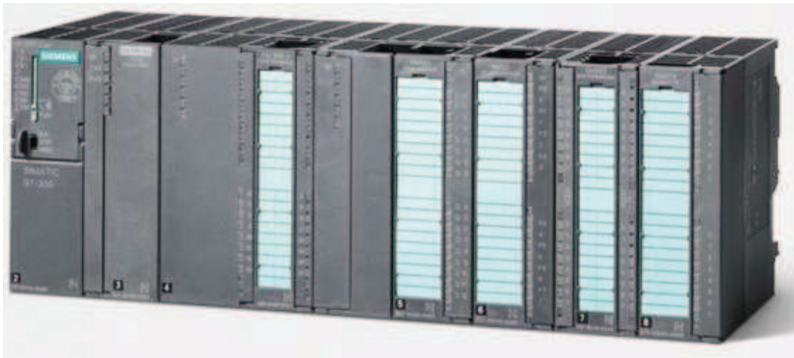
Fig (IV.1) Structure d'un API S7-300
