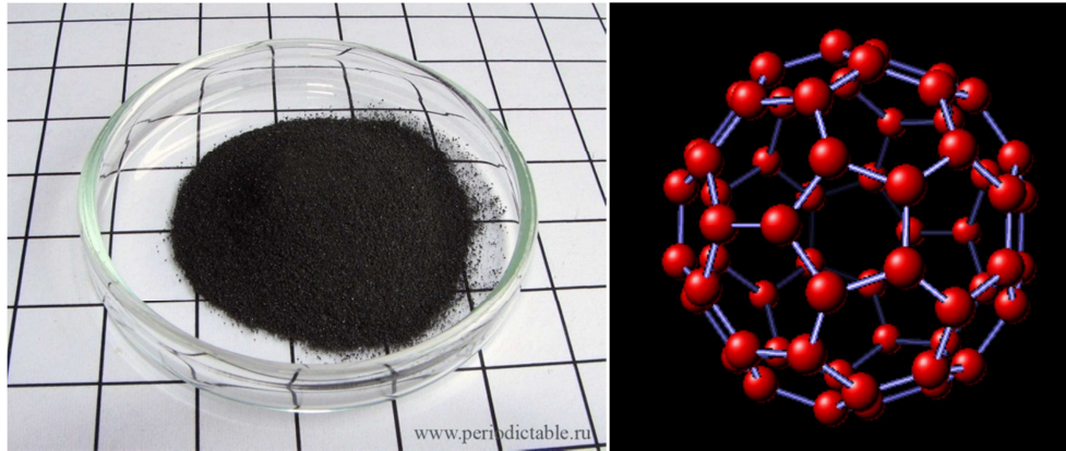
Figure (I-5) : (à gauche) poudre de fullerène C_{60} , (à droite) fullerène C_{60} comportant 20 hexagones et 12 pentagones.
