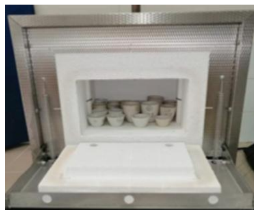
creusets à l'intérieur du Four
