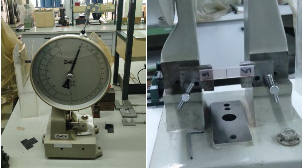
Figure IV.11. Machine de résilience (zwick).
