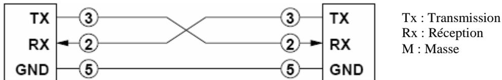
Figure II-3 : Liaison entre l'émetteur et le récepteur RS232.
