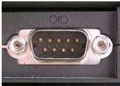
Figure II-2 : Broches (pins) du connecteur DB9 (mâle)
