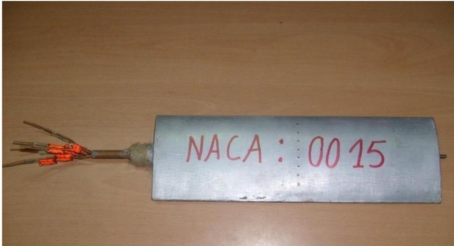
**Figure III.9 :** Pale rectangulaire munie de prises de pression.
