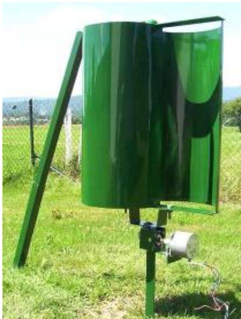
**Figure I.6 :** Eolienne de type Savonius.
