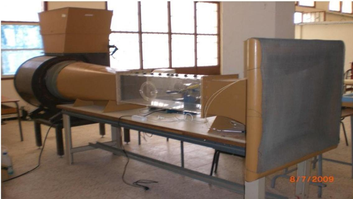
**Figure III.1.a :** La soufflerie Delta-Lab EA103 du laboratoire
