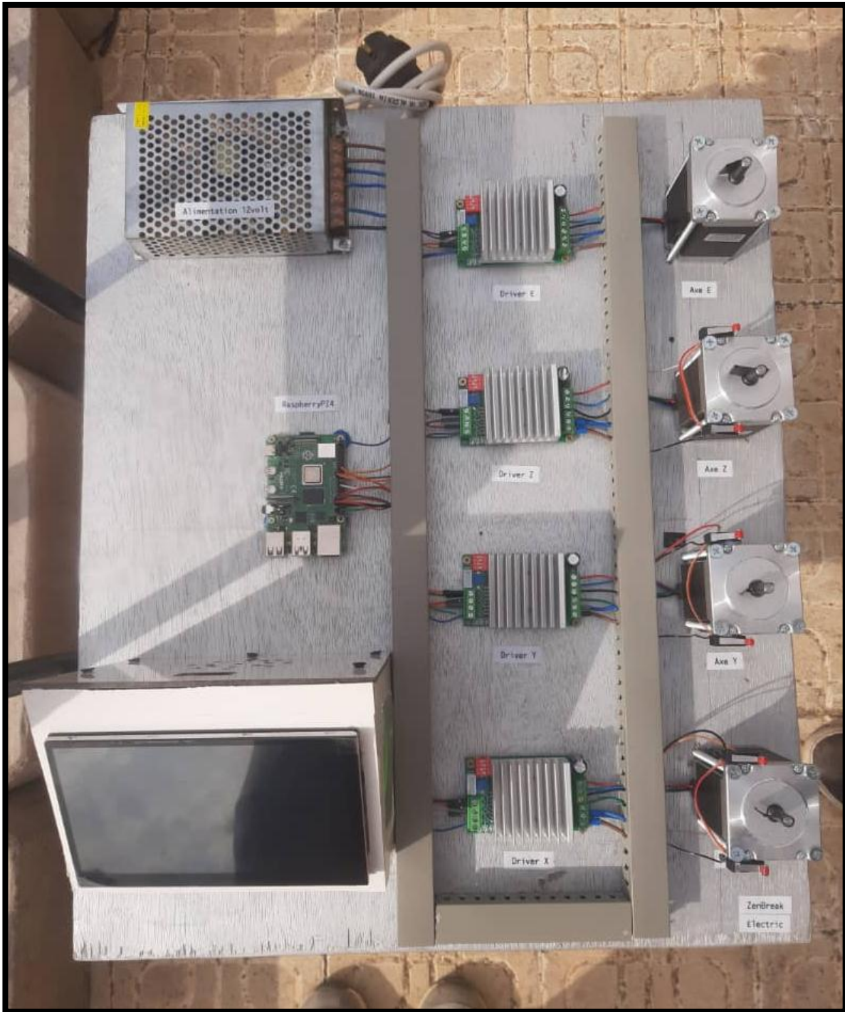
Figure 52 : vue de dessus du circuit électrique
