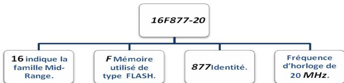
Figure16. Configuration du pic 16F877
